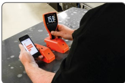
Idóneo para medir espesor de la película seca en sustratos de revestimiento fino
