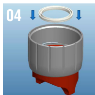
4.- Colocar junta en la posición indicada
