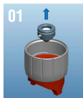
1.- Retirar el TIP de la boquilla
