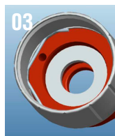
3.- Útil colocado dentro de la boquilla
